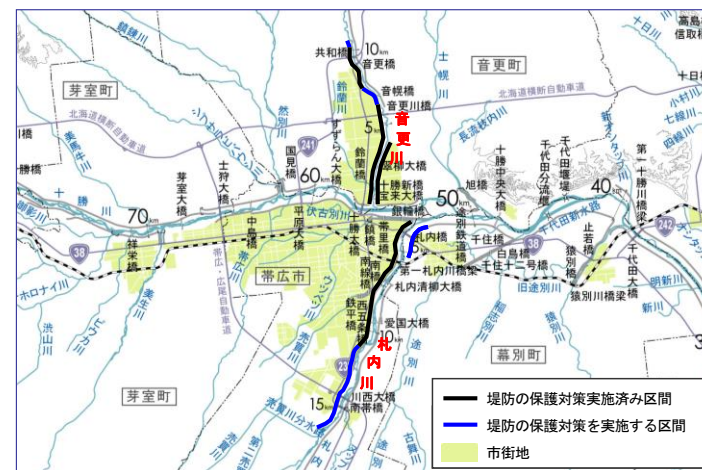
図 2-4 堤防の保護対策を実施する区間（音更川、札内川）
