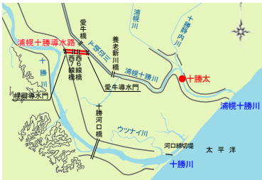
図 1-13 浦幌十勝導水路
