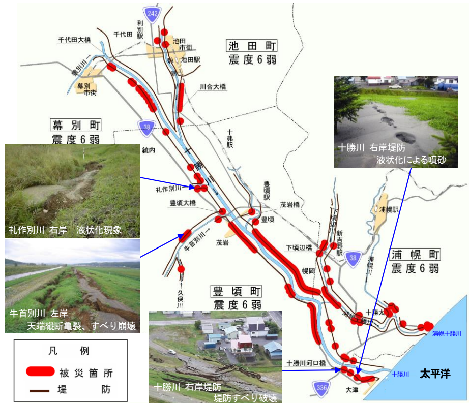
図 1-16 平成 15 年 十勝沖地震 堤防の被害状況
