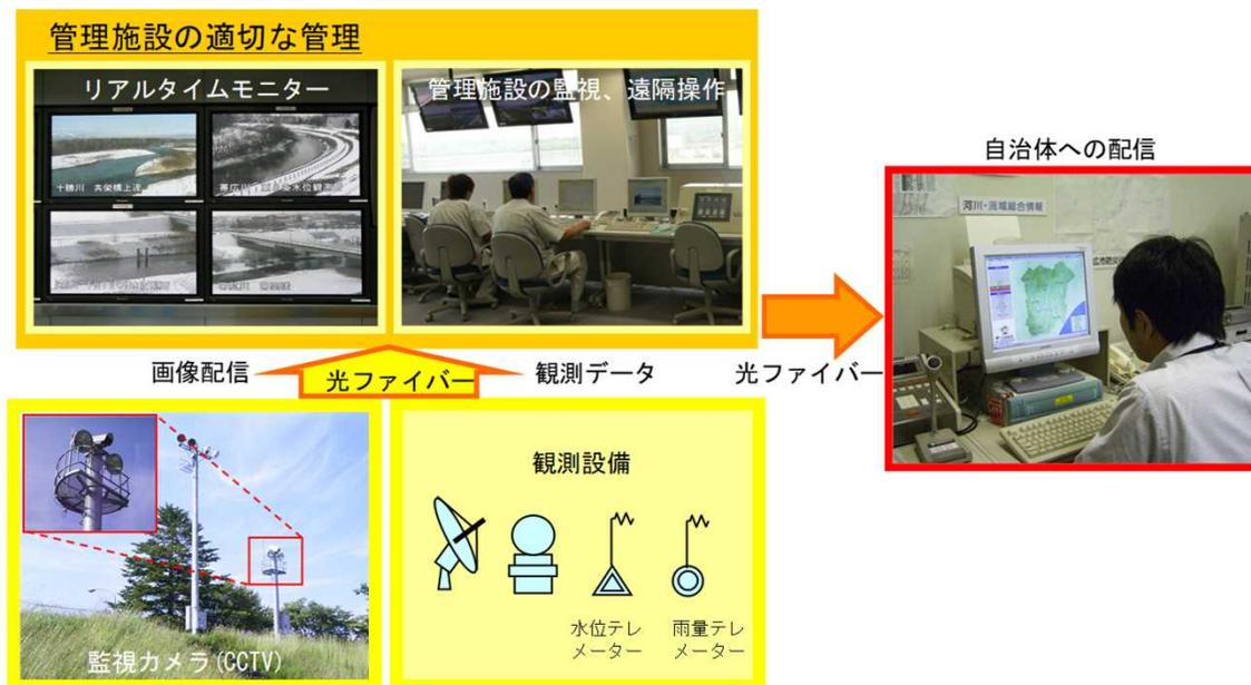
光ファイバー網による河川情報の収集・伝達のイメージ図
