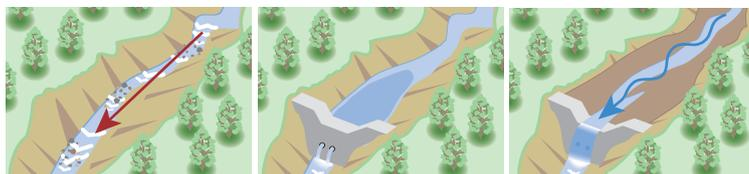
砂防堰堤は河道の勾配を緩やかにして、大雨時の急激な土砂の流下を防ぐ
