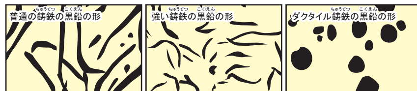
いろいろな鑄鉄の黒鉛を顕微鏡で見た時のイメージ(100倍)。
