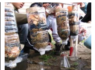
ろ過する時の、一つのかたち。小石を上から大きい順になるように入れて、大きめのゴミから除く。いろいろな材料を、いろいろな順番に入れてみる。(道立十勝エコロジパークの自然観察会より)
