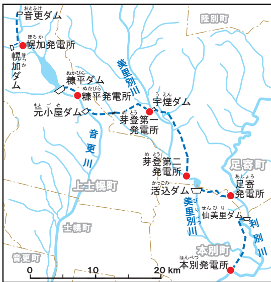
糠平ダム以降の5発電所に幌加発電所も加え、「糠平系」と呼ばれる。
