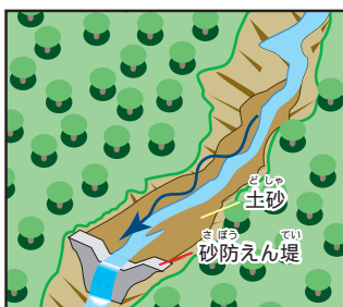
土砂がたまりと流れ下る土砂の勢いがゆるまり、上流側では川の周りがけずられにくくなる。
