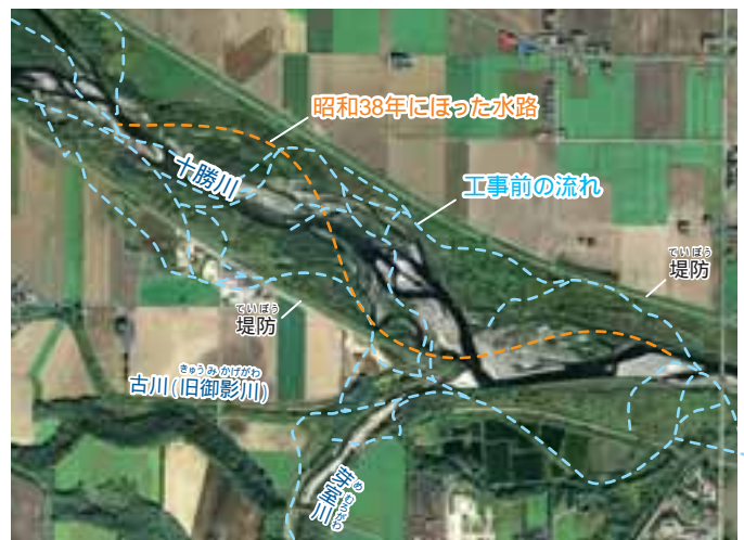
平成17年(2005)の芽室川合流点の十勝川。オレンジ色の点線が昭和38年(1963)にほった部分。水色の点線は、工事前のおもな川の流れ。
