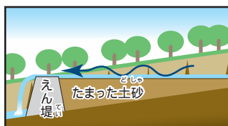
土砂がたまりと流れ下る土砂の勢いがゆるまり、上流側では川の周りがけずられにくくなる。
