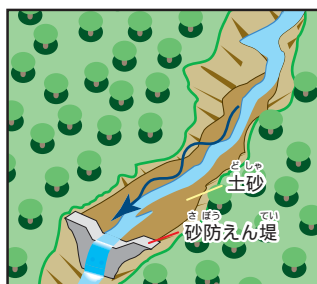
土砂がたまりと流れ下る土砂の勢いがゆるまり、上流側では川の周りがけずれにくくなる。
