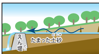
土砂がたまりと流れ下る土砂の勢いがゆるまり、上流側では川の周りがけずれにくくなる。
