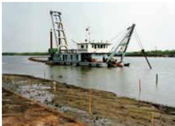
川底の土砂を水ごと吸い上げてしゅんせつするポンプ船。土砂は河川敷の「排泥池」で水をぬいたあと、堤防づくりなどに使われる。
