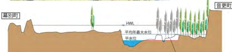
左岸を平水位で掘削
