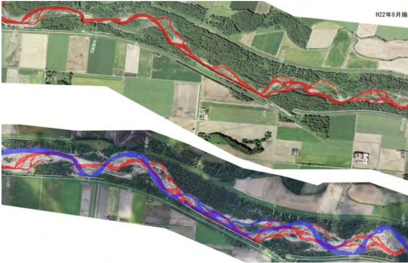
図-5 出水前後の蛇行形状の変化(上:出水前、下:出水後)
