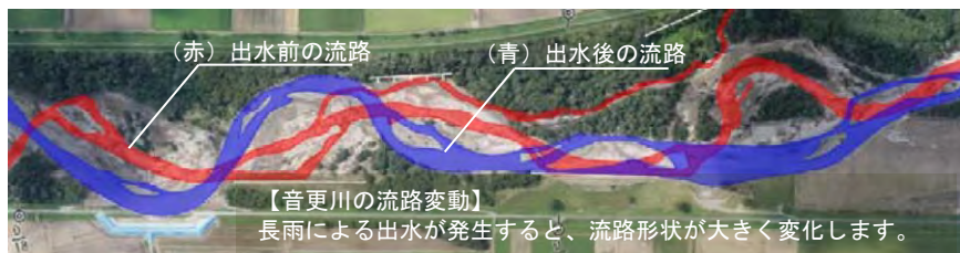
図-2 出水前後の流路位置の変化(音更川) (赤線は出水前、青線が出水後。写真は出水後のH23.9.7に撮影)
