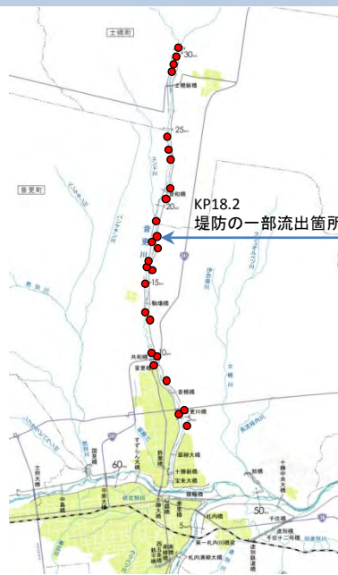
図-1 河岸侵食の発生箇所 (侵食幅20m以上の箇所は26地点)
