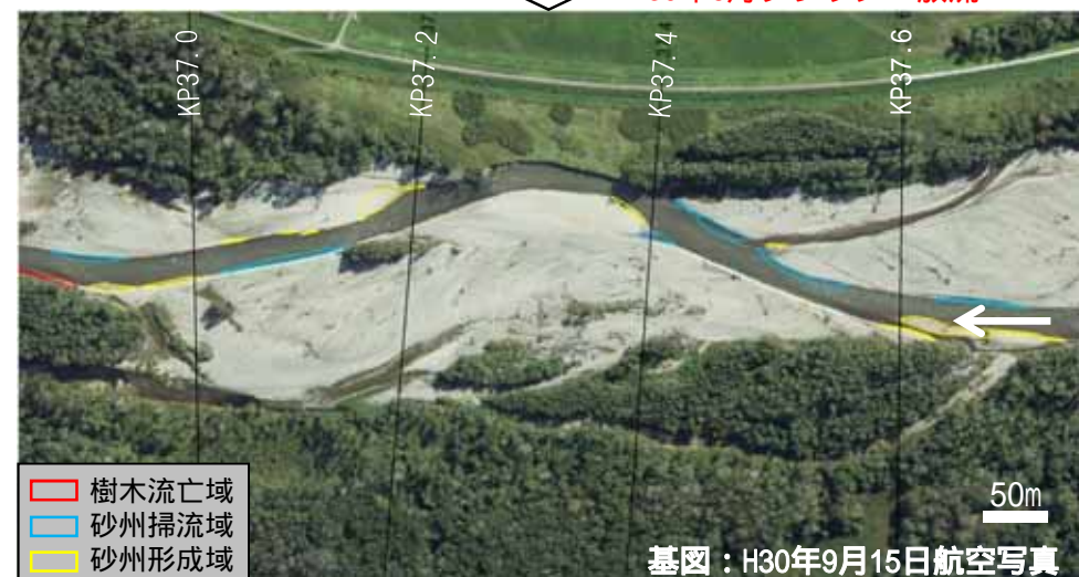
図-2 H30年6月フラッシュ放流による河道内変化状況
