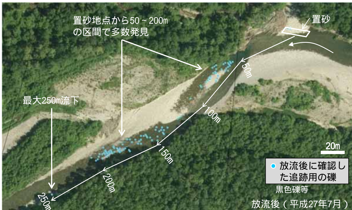
図-2 フラッシュ放流により掃流された置砂の追跡調査結果
