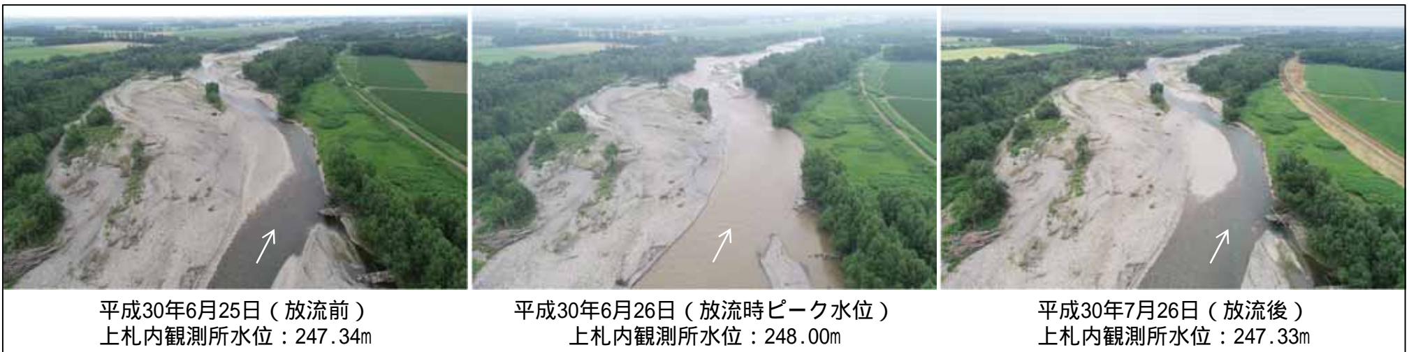
図-2 対照工区のH30年6月フラッシュ放流前～後の状況
