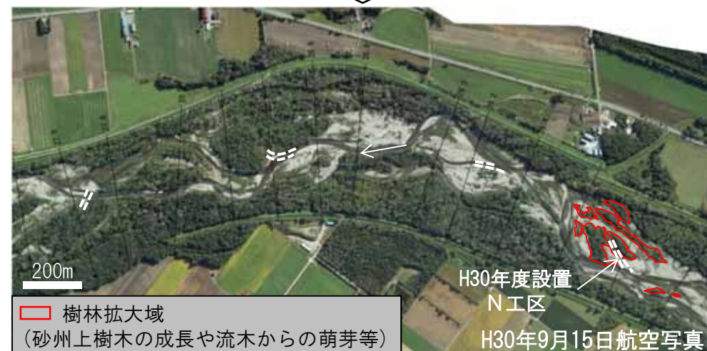
図-2 H30年6月放流による河道内変化状況
