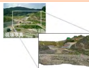
取得したレーザースキャナーデータに写真を重ねて三次元モデリングした事例※ 任意の断面で横断面を作成できる
