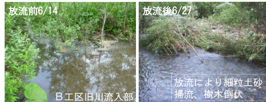
写真-1 旧川引き込みB工区 H25放流前後の旧川流入部の状況
