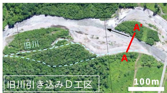
図-2 ダム放流による主流路と旧川の比高差縮小効果 (H25年D工区の事例)
