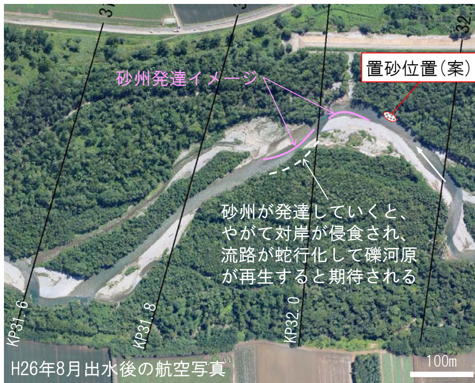
図-13 KP32.0付近への置砂位置(案) 砂州の発達と将来の流路蛇行化のイメージ
