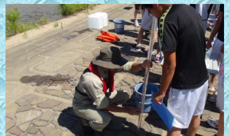
川から水を採取し、透視度計や試験薬等を使って水質を調査しました
