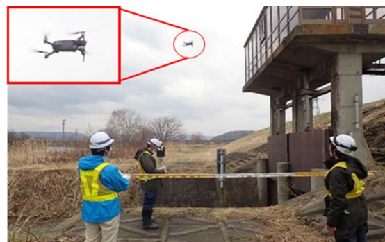
AI 技術による樋門等構造物の変状確認・評価 (AI/Eye RIVER)
