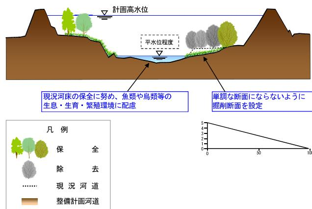
図 2-1 河道の掘削のイメージ図
