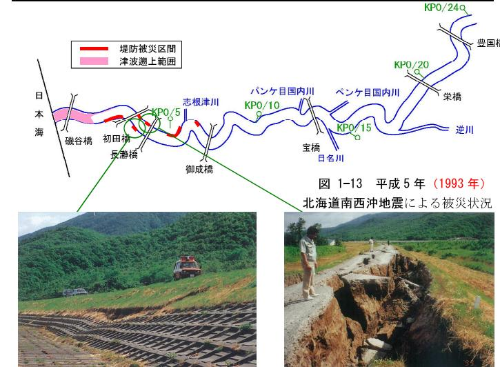
図 1-13 平成5年(1993年)北海道南西沖地震による被災状況
