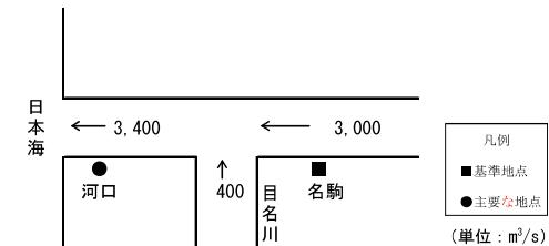
平成 22 年(2010 年)4 月には、当面の目標として、目標流量を名駒地点で  $2,000\text{m}^3/\text{s}$  とする尻別川水系河川整備計画(以下、「前河川整備計画」という。)を策定した。この計画に基づき、流下能力が不足している箇所で河道掘削を実施している。
