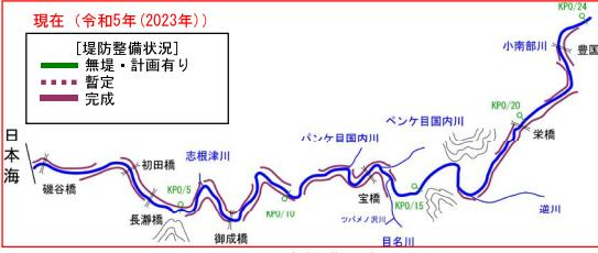
平成 9 年(1997 年)の河川法改正に伴い、平成 20 年(2008 年)3 月に尻別川水系河川整備基本方針を策定した。この基本方針では、既定の工事実施基本計画を検証のうえ、名駒地点の基本高水のピーク流量を  $3,300\text{m}^3/\text{s}$  とし、洪水調節施設により  $300\text{m}^3/\text{s}$  の調節を行い、計画高水流量を  $3,000\text{m}^3/\text{s}$  とした。
