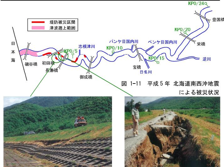
図 1-11 平成5年 北海道南西沖地震による被災状況
