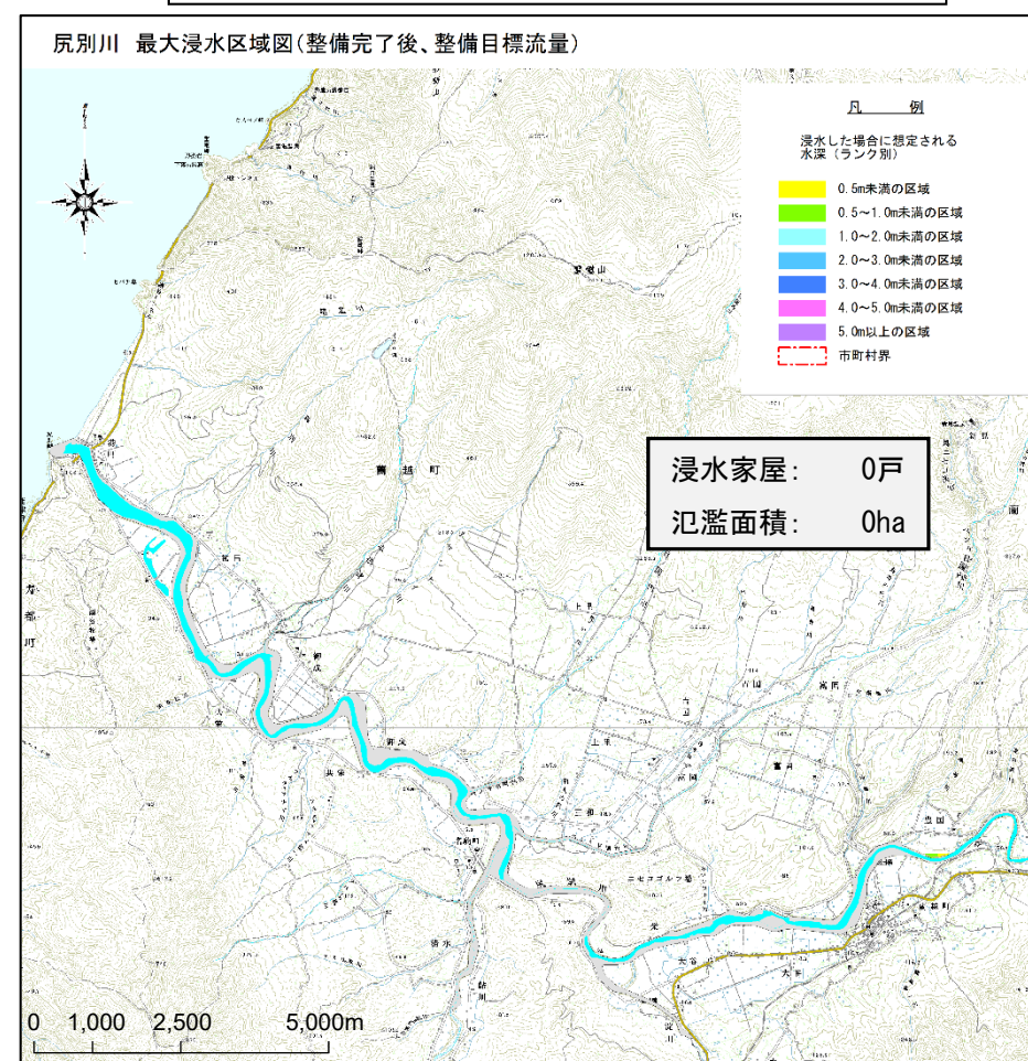
図5-1 対象とする洪水における洪水流量が流下した場合の浸水状況
