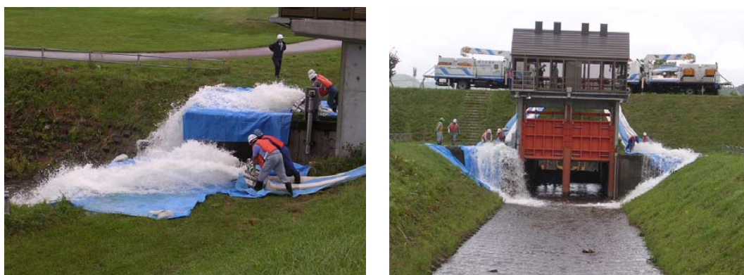
排水ポンプ車による排水（訓練）
