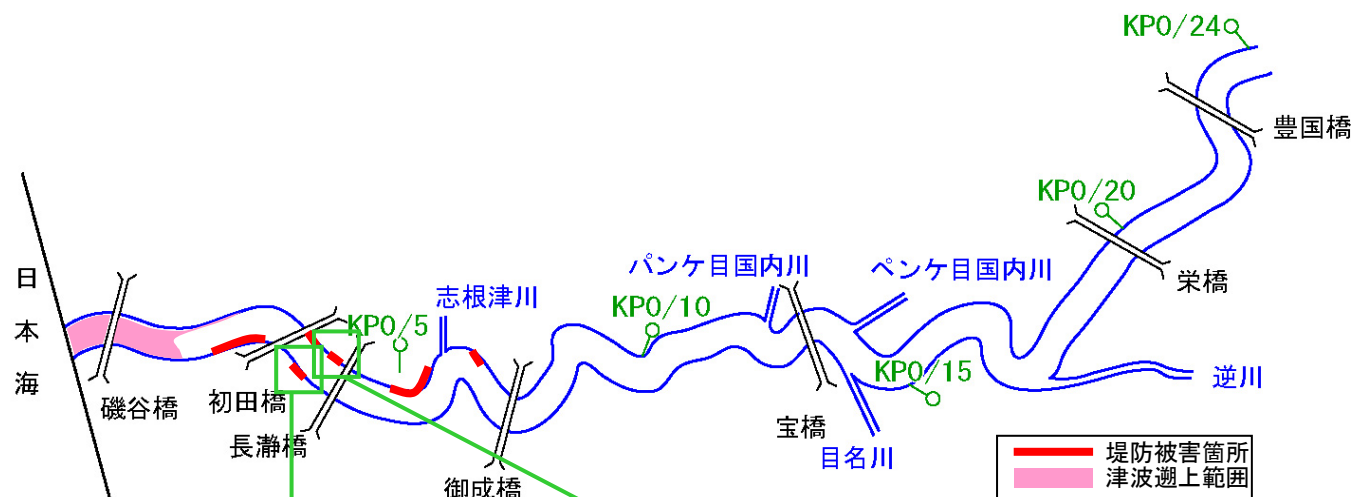
北海道南西沖地震による堤防被害箇所
