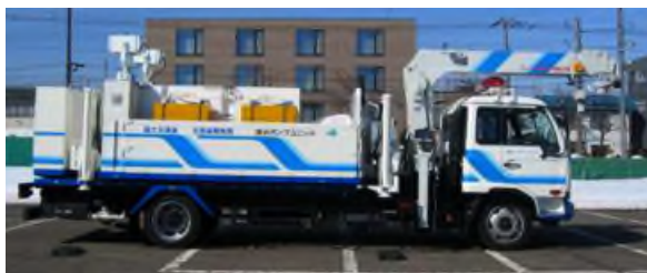
（排水ポンプ車）
