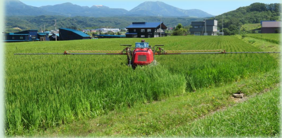
農薬はブームスプレーヤーという機械で散布しています。
