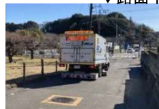
(空洞探査車による調査)
