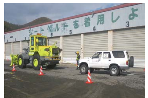
除雪車による牽引状況
