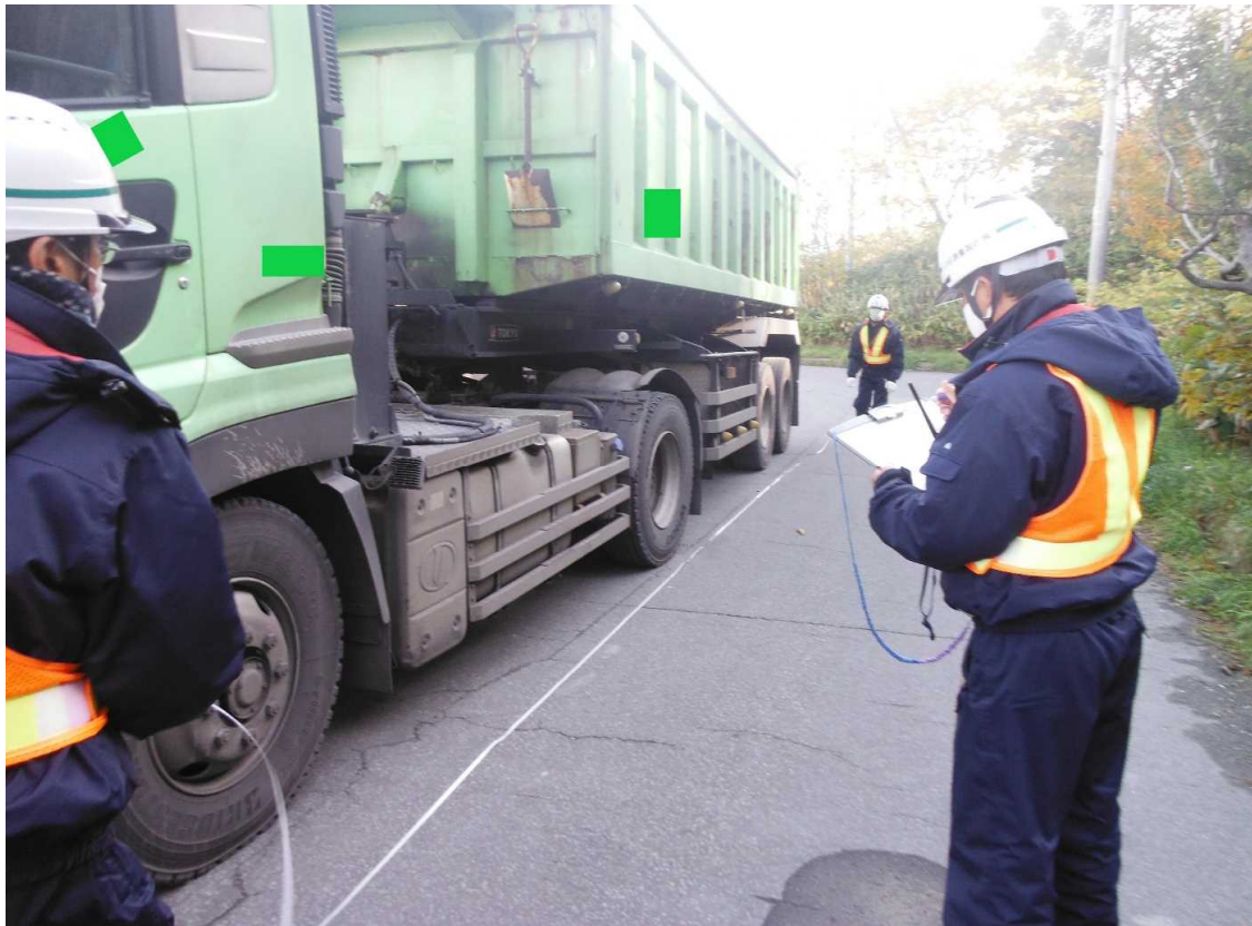
車両諸元(長さ)の計測
