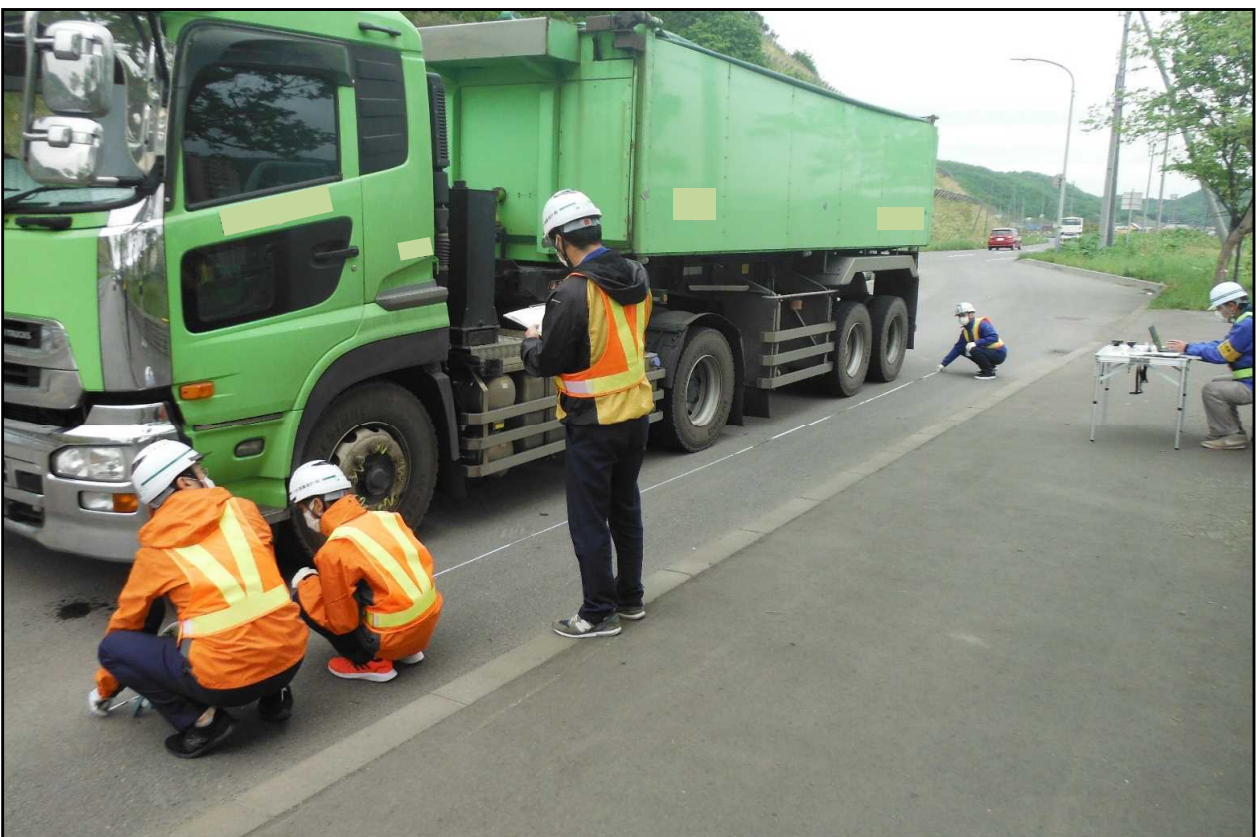
車両諸元(長さ)の計測
