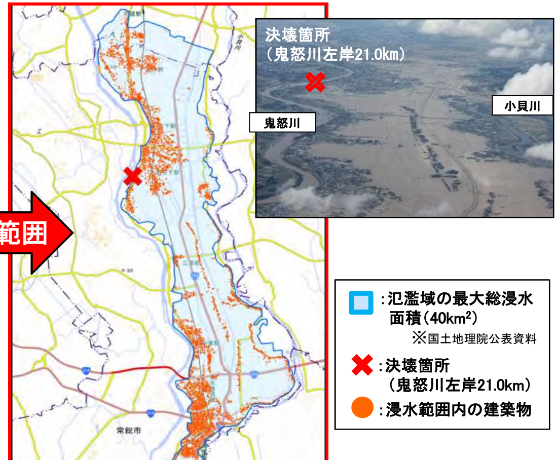
H27. 9. 11鬼怒川氾濫における最大浸水区域
