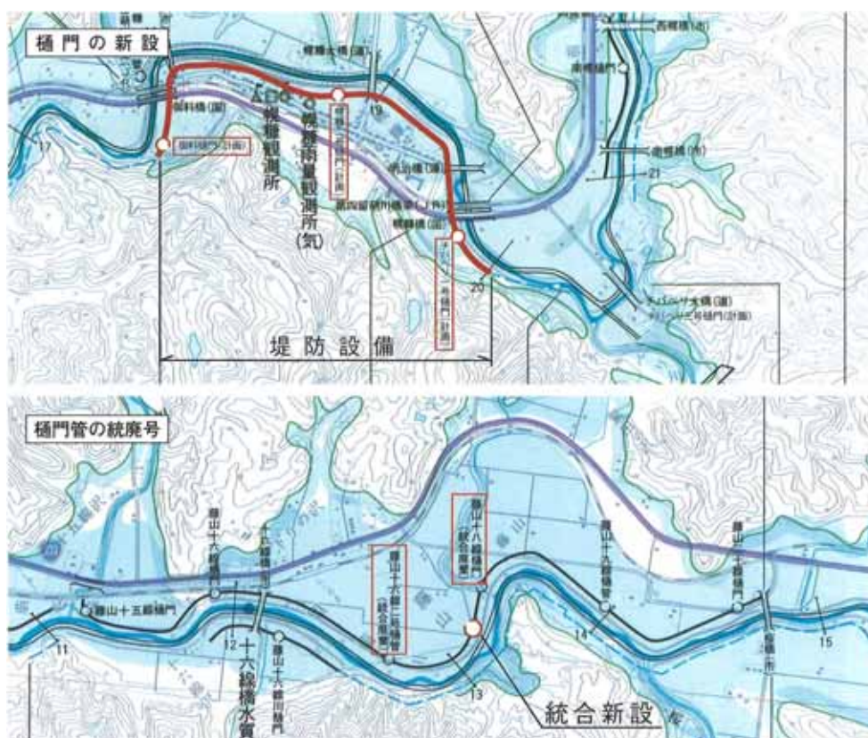
図2 - 9 樋門管の新設・統廃合箇所 (S=1 : 25,000)
