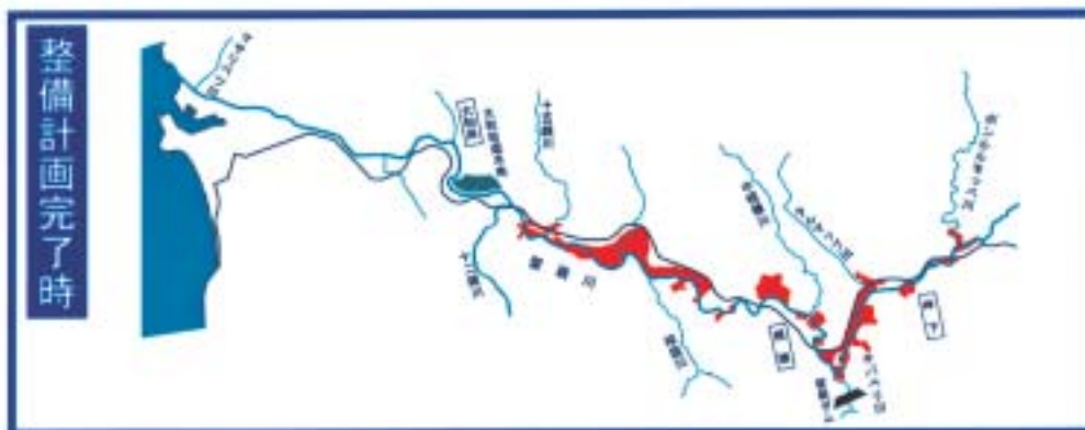
図 1 - 2 昭和56年8月及び昭和63年8月洪水規模の降雨による氾濫イメージ図
