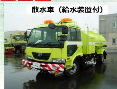
本機械は、国道の散水作業に使用する散水車に給水装置を搭載することにより、給水活動にも利用できる構造となっているほか、各種施設の給水タンクなどに水を圧送する機能も備えています。
