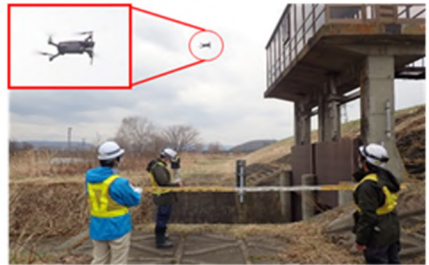
AI 技術による樋門等構造物の変状確認・評価 (AI/Eye RIVER)
