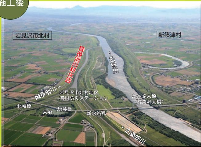
幾春別川に旧美唄川を合流し、計画高水流量 $1,400\text{m}^3/\text{s}$ を流下させ、石狩川本川との合流点を $5.4\text{km}$ 下流に移すことにより、石狩川の背水の影響を軽減します。
