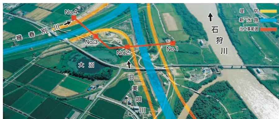
幾春別川と旧美唄川の河道切り替えて、機能に支障が生じる幌達布第1幹線用水路と美唄達布幹線用水路を、泥土式シールド工法を採用しサイフォンで両河川を横断させました。
