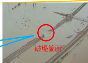
S56. 8月の洪水時の堤防決壊状況 (産化美唄川)
