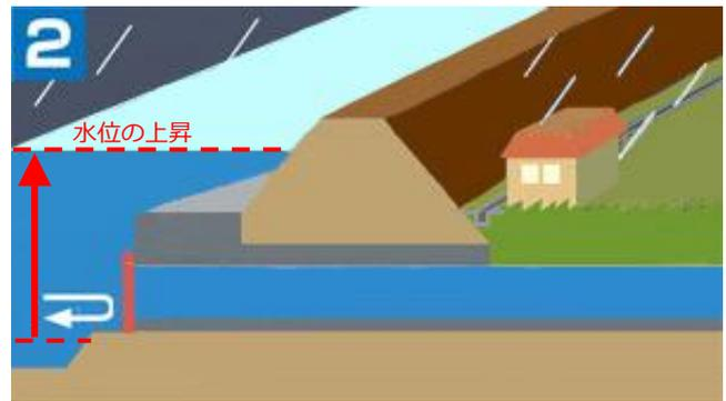
洪水時には、川に雨水が集まり、水位がより上昇し、排水路に逆流する場合があります。逆流に伴い水害が発生するのを防ぐため、ゲートが閉まります。
