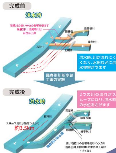
旧美唄川開基橋下流で約1.4m、幾春別川北橋橋(道道)下流で約1.2mの水位を下げる効果があります。
