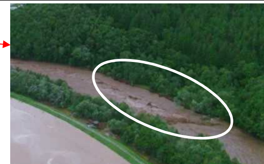
【太平橋下流で射流※が発生】
