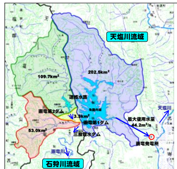
図 1-20 天塩川への放流状況
