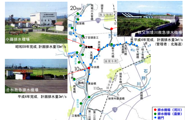
図 1-10 内水排水施設
