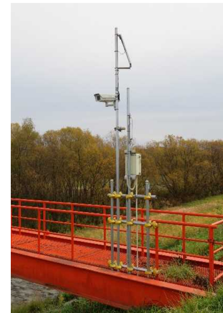
簡易型河川監視カメラ(左)、危機管理型水位計(右)
