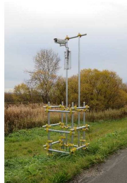
簡易型河川監視カメラ(左)、危機管理型水位計(右)
