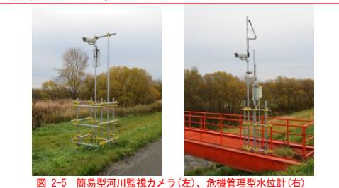
図 2-5 簡易型河川監視カメラ(左)、危機管理型水位計(右)
