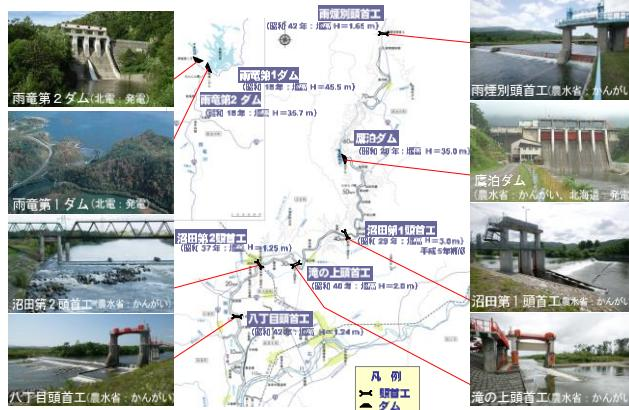
図 2-8 落差のある横断構造物
