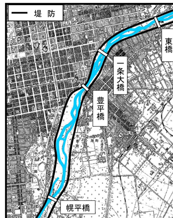
右岸への市街地拡大に対応し、右岸堤防を連続化
