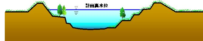
洪水流下の支障となる樹木が繁茂すると、河積が小さくなり水位が上昇する。
