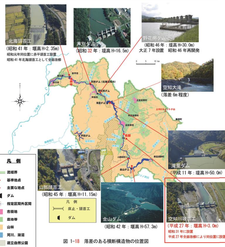
図 1-18 落差のある横断構造物の位置
