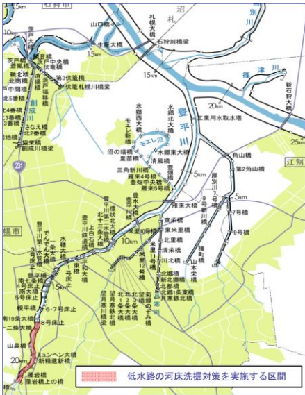
図 2-6 低水路の河床洗掘対策を実施する区間
