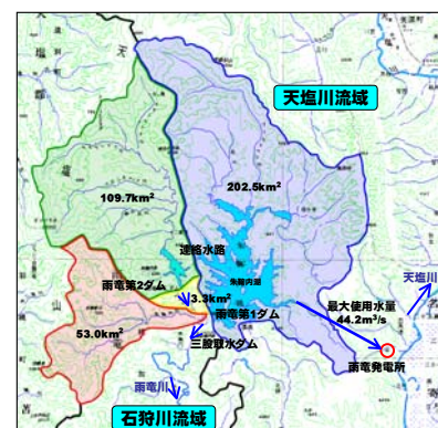
図 1-20 天塩川への放流状況
