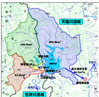
図 1-20 天塩川への放流状況
