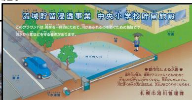
雨水管の機能を増強する下水道工事の実施や、住宅建築等における浸透枠の設置指導を継続実施。
