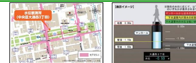
・地下街近くの下水道水位をリアルタイムで閲覧できる「札幌市下水道水位情報システム」を構築し、地下街の事業者へ周知
