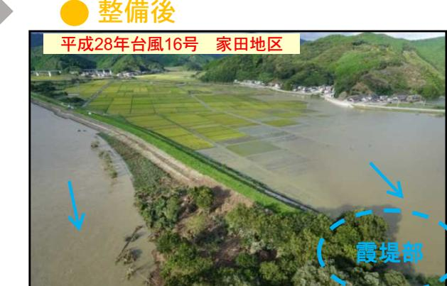
霞堤からの流水により浸水しているが宅地嵩上げにより家屋浸水は大幅に低減！
