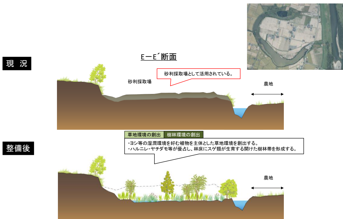
図 3-23 鳥類の生息環境の改善のための整備イメージ (E-E' 断面)
