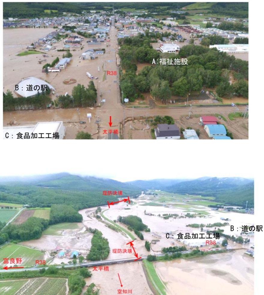
図 2-15 幾寅市街部の被災状況
